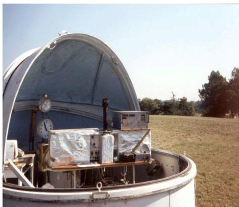
Figure 5. Instrument Dobson à l'intérieur de sa coupole.
